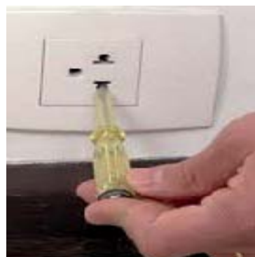
Fig. 3 - Identificando o neutro com a chave de teste
