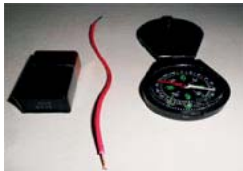
Fig. 7 - Material para experiência de Ørsted
