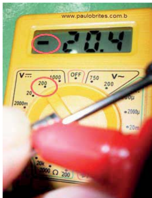
Fig. 7 - Medindo a tensão no plug de um notebook
