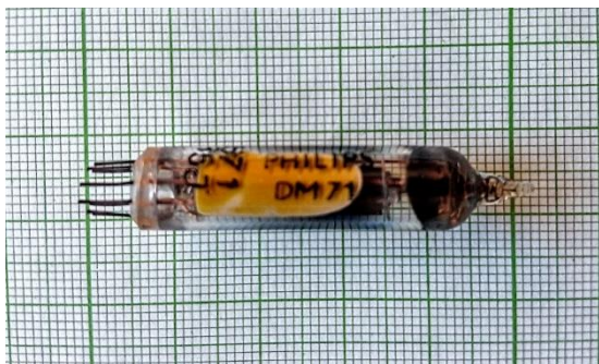
Válvula Philips subminiatura, tipo DM71, vista pela parte traseira do “ponto de exclamação”.
