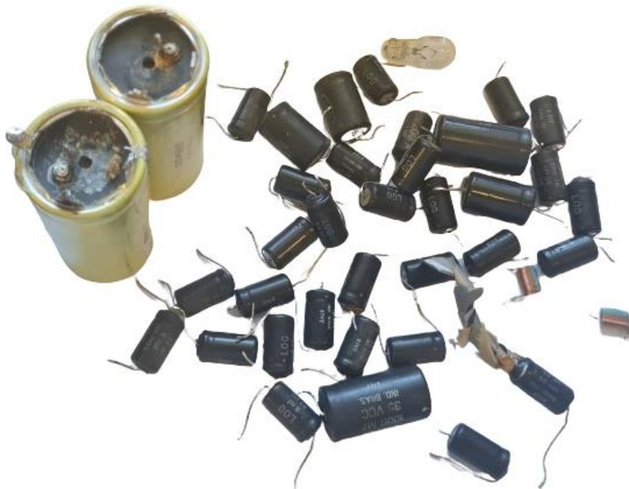
À exceção dos capacitores maiores, todos os demais são da marca LOG, e a placa principal do PRO 1200 ficou meio esquisita com a montagem deles, parecendo que ela não foi feita para eles. Todos os furos de conexão dos capacitores menores são bem próximos, para componentes radiais, e eles são axiais, e bem maiores.
