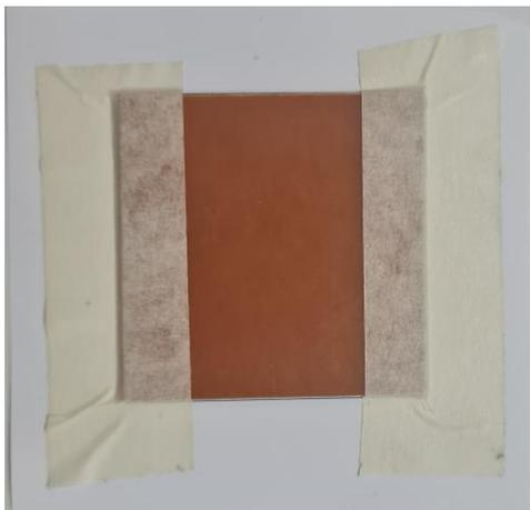
A seguir, pressione o ferro de passar roupas, que deverá estar na posição de temperatura máxima, sobre o lado do papel, de forma que ele se aqueça uniformemente. Então, com a ponta do ferro, coloque bastante pressão e passe-o sobre toda a superfície, caprichando nas bordas, em movimentos circulares. Na maior parte das vezes, as falhas na transferência do toner para a placa ocorrerão nas bordas, portanto, capriche aí. Passe várias vezes até que o papel tenha esta aparência.
