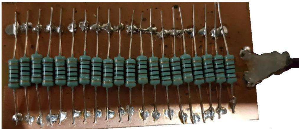
Conforme vocês viram nas fotos, eu soldei os resistores direto no lado cobreado.
