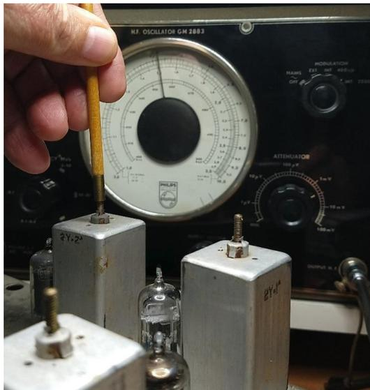
**Figura 2.** Gerador de sinais de RF ou oscilador de teste, mesmo de tipo antigo, é recomendável para quem pretende se dedicar seriamente às reparações ou restaurações. Para resultados adequados, não se recomenda a calibração “de ouvido” — sem o uso de instrumental.
