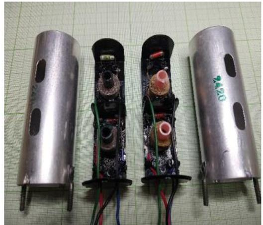
**Figuras 7 e 8.** Um atenuador ajustável na saída do gerador de sinais é útil para evitar efeito de sobrecarga nos circuitos sintonizados do receptor: a calibração deve ser feita com o sinal reduzido ao mínimo. À direita, transformadores de FI da Induco: há núcleos cujo ajuste deve ser feito com uma pequena chave de calibração, plástica, com ponta hexagonal.
