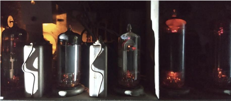
***Figura 1. Pelo ajuste criterioso das frequências dos circuitos sintonizados, como o dos transformadores de FI, torna-se possível o máximo rendimento dos radiorreceptores. Na fotografia, iluminados entre as válvulas, estão transformadores de frequência intermediária com ajuste por permeabilidade no topo, tanto do primário como do secundário, o que facilita a operação de calibração.***
