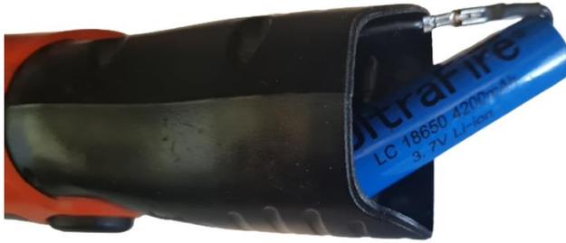
E tudo funcionou bem. O cuidado maior é com a substituição da bateria. A bateria padrão 18650 de Íon-lítio cabe no espaço da outra, mas os fios de conexão têm que ser soldados. E temos que ter cuidado com isso. Baterias desse tipo são muito sensíveis ao calor. Há suportes para elas, mas, no meu caso, preferi soldar, com solda comum, pois não tenho equipamento para solda de ponto.
