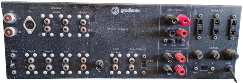
O painel traseiro é bem completo, apresenta a possibilidade de separação entre a etapa de potência e as etapas de sinal, além de possibilidade de inversão de fase na saída de sonofletores I. Bornes de conexão, aliás de muito boa qualidade, sendo que um par deles foi substituído em alguma manutenção desta unidade.
