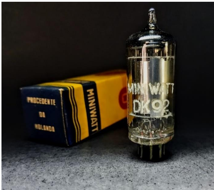
Figura 4. Válvulas de 1,4 V, como a notável DK92/1C2 da foto, uma heptodo conversora originalmente projetada para receptores a baterias, possuem um limite estreito para tensões máximas e mínimas de funcionamento do filamento. A DK92 era capaz de funcionar até 30 MHz. Exigia uma tensão de oscilação baixa na grade osciladora G1 (apenas 4 V RMS) e era capaz de manter a oscilação, mesmo com as tensões de filamento e anodo descendo a 1,1 e 65 V. Acima do limite máximo, de 1,5 V, na maioria das válvulas desse tipo o filamento pode se romper ou a durabilidade da válvula ficar severamente prejudicada: de uma expectativa média de 5.000 horas, por exemplo, a vida útil da válvula pode cair para apenas 100 horas ou menos, dependendo do tipo e da marca. Válvulas como a DK92 requerem tensões nominais de filamento diferentes para a alimentação em paralelo ou em série: 1,4 V (paralelo) e 1,3 V (série).
