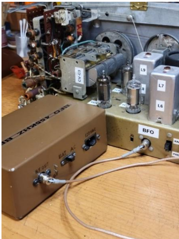
Figura 2. A inserção do sinal de batimento, no caso do Zenith Transoceanic A600L do Autor, foi feita aproveitando-se o conector “fono”, sem uso, do receptor. O OFB descrito injeta um sinal ajustável de 452 a 458 kHz.
