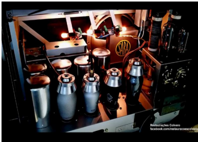
Figura 8. Restaurações esmeradas como a deste Saba modelo 448GWLK, de 1937, executadas pelos colegas Amauri e Fabrício Colvero , além de preservarem uma parte da memória da tecnologia termiônica, podem fazer reviver os equipamentos históricos em toda sua plenitude, com excelente seletividade e sensibilidade, além de som de qualidade.
