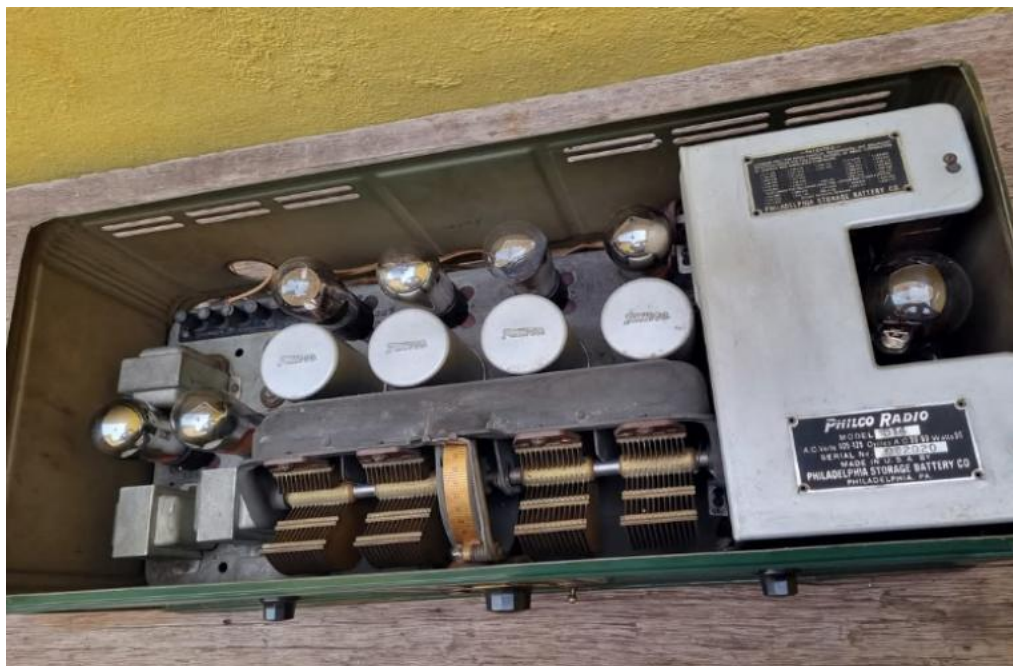
Figura 6. Vista interna do Philco modelo 514, de 1928. Rádios com gabinete impecável e funcionando perfeitamente, com os componentes originais, sem intervenções modernas são o santo Graal para os apreciadores da retrônica. — Foto: exemplar da coleção de Andreas Triantafyllou.
