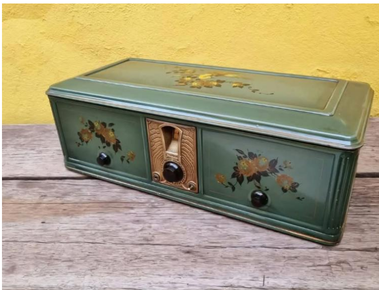
Figura 5. Philco modelo 514, de cor verde Nilo, com pinturas artísticas, de 1928. Em gabinete de aço, neutrodino, com válvulas tipo 26 (quatro), 27, 71 e 80. Nas restaurações não apenas importa o bom funcionamento e a originalidade: o estado de conservação e a beleza estética valorizam o objeto. — Foto: exemplar da coleção de Andreas Triantafyllou, de São Paulo.
