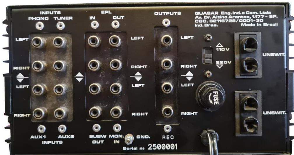
Seu painel de conexões traseiro é completo também, dentro do que um gabinete pequeno permite: Entradas padrão RCA, duas saídas para subwoofer e as conexões EPL, além da saída de linha e uma de monitoração (REC). Fusível de proteção, seleção de tensão de rede elétrica e duas saídas não-comutadas complementam o conjunto.
