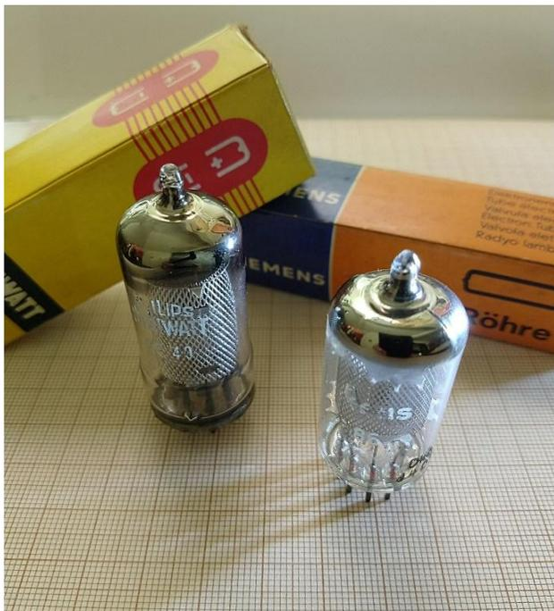
**Figura 9.** À esquerda, na foto, uma Philips Miniwatt **EF40**, tipo Rimlock. À direita, a famosa **EF86**, muito louvada pelos audiófilos, tipo noval. Pouca gente sabe, mas a EF40, atualmente de preço muito mais acessível, foi a precursora da EF86, apenas com base diferente. Ambas apresentam características elétricas muito semelhantes. Para mais detalhes sobre as diferenças elétricas entre a EF40 e a EF86 vide o texto.
