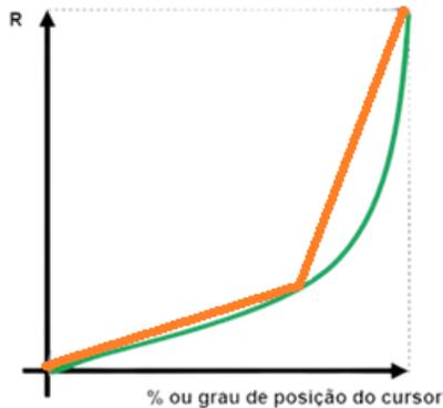
**Fig. 3 – Curva de um potenciômetro logarítmico comercial**
