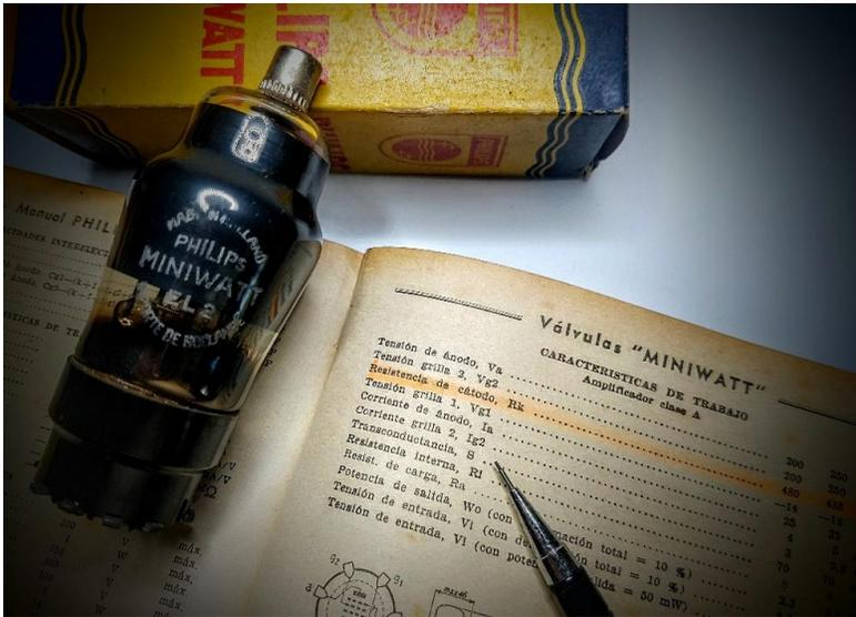
**Figura 5.** A especificação de **Rk**, resistor de catodo, para a operação característica é informada em alguns manuais, dispensando o cálculo, salvo que se altere a classe de funcionamento da válvula. Na foto aparece o pentodo de saída Philips Miniwatt tipo EL2. Com tensão de placa de 200 V e polarização de grade em -12 V, com a válvula EL2, operando como amplificadora classe A, terá um valor recomendado para o resistor de polarização de catodo de 480 Ω.
