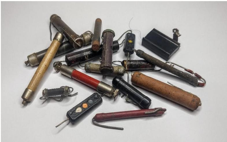
**Figura 4.** Resistores de tipos antigos, com defeito ou com valores ôhmicos ilegíveis. Como calcular resistores de reposição para a polarização de catodos? Detalhes no texto. Não se confunda: na foto, parece ser capacitor de mica, mas não é. É resistor, ou “resistência”, como se dizia antigamente.
