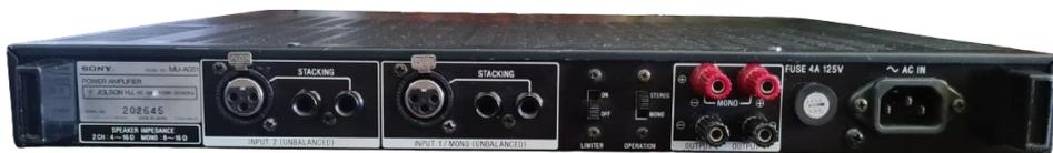
Seu painel traseiro tem as conexões padrão para unidades de potência, e também características que começam a mostrar suas qualidades para uso profissional: conectores XLR e P10, com capacidade de distribuição empilhada (“stacking”) e possibilidade de operação em ponte (“bridge”); uma chave adicional limita a potência máxima de saída, conector de força IEC e fusível de linha completam este painel. Simples, funcional e completo.
